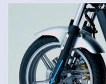
**NEW** Les éléments de la confortable fourche de ø 41 mm sont largement écartés pour un comportement facile et vif mais aussi pour un contrôle digne des meilleures supersports.
