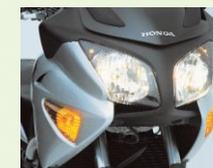
**NEW** Les versions basiques ou semi-carénées sont disponibles. La version habillée comprend un demi-carénage avec un double optique à multiréfecteur et une bulle réglable en 2 positions pour améliorer le confort et la protection.
