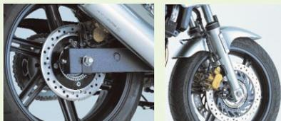
**NEW** Les magnifiques jantes à 6 bâtons apparaissent légères, modernes et sportives. Elles accueillent des pneumatiques radiaux hautes performances et sont freinées par une paire de disques de  $\varnothing$  296 mm munis d'étriers double pistons à l'avant et un disque de  $\varnothing$  240 mm à étrier simple piston à l'arrière.
