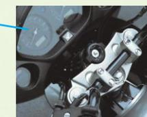
**NEW** Les supports de guidon peuvent être retournés à 180°, permettant d'avancer le guidon de 10 mm et de déterminer ainsi une position de conduite plus confortable pour les utilisateurs les plus grands.
