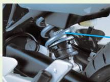
**NEW** La robuste suspension arrière Monoshock, avec son bras oscillant en acier et son amortisseur HMAS, assure un comportement parfait dans toutes les conditions.
