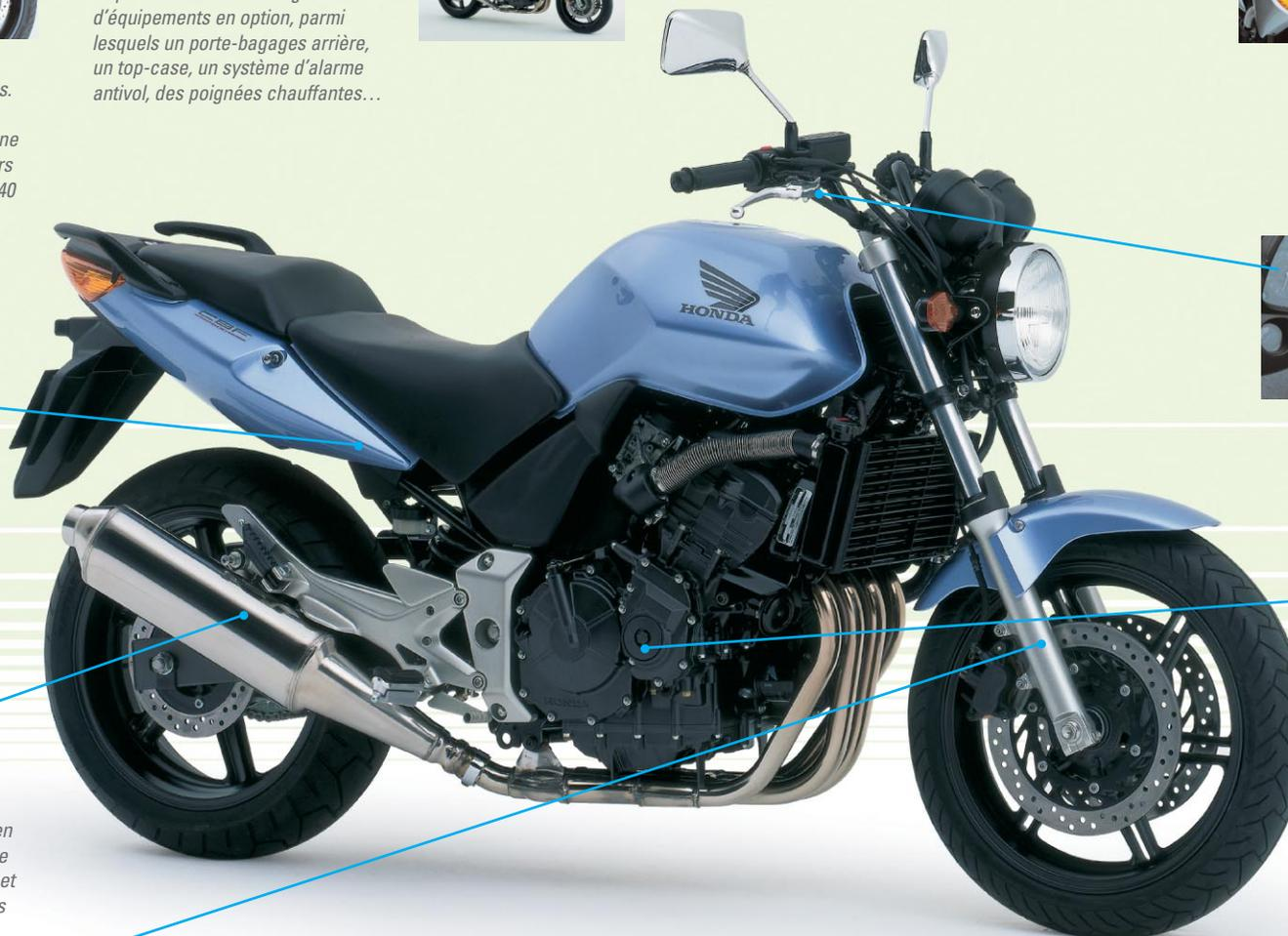
**NEW** Le système d'échappement 4 en 2 en 1 en acier inoxydable s'achève par un large silencieux ovale. Le système Air Induction et les tubes catalytiques conservent les rejets polluants bien au-dessous des normes EURO-2.
