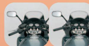
En faisant pivoter les supports de guidon de 180°, on peut l'avancer de 10 mm pour offrir plus de confort aux utilisateurs les plus grands.
