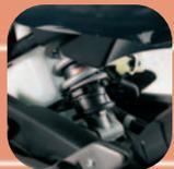
La suspension arrière Monoshock est associée à un robuste bras oscillant en acier et à un monoamortisseur
