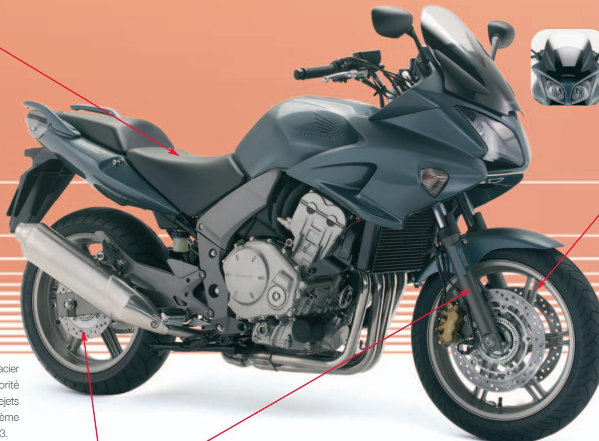
Les roues adoptent un dessin moderne et dynamique. Elles sont chaussées de pneumatiques radiaux hautes performances et freinées par un double disque de  $\varnothing$  296 mm avec étriers 4 pistons à l'avant et un disque de  $\varnothing$  240 mm avec étrier simple piston à l'arrière.
