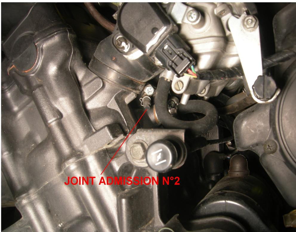
Nota : vous remarquerez les emplacements des prises de dépression (joints d'admission) des carburateurs 1 et 2 sont «inversés» sur le plan vertical (voir schéma de principe).
