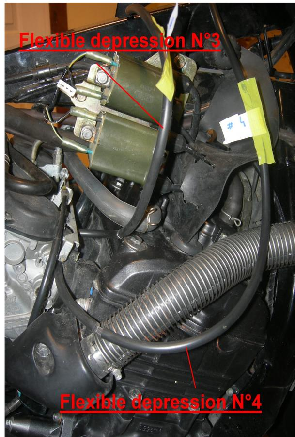
Nota : les prises de dépression sont des petits tubes en laiton, façon têtine.
