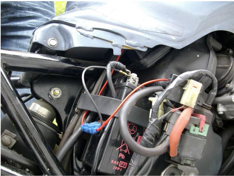
7) Avant de tout remonter, essayer de brancher un gps pour tout contrôler et tourner également le guidon pour être sûr qu'il y ait assez de mou à la direction! Si l'ensemble fonctionne bien, retirer juste le fusible tout en gardant votre système branché pour être sûr qu'une fois retiré, votre chargeur ne fonctionne plus.
