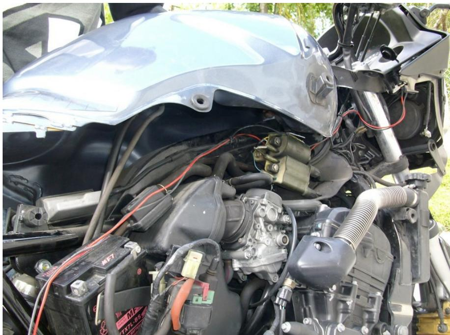
5) Une fois que le câble est passé proprement et qu'il tient, il faut penser à installer le fusible de protection. Il faut couper le fil rouge et le faire passer dans le support à fusible en revanche il ne faut pas couper le fil noir et il ne faut pas le faire
