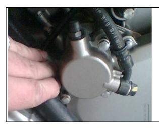
Puis on démonte l'ensemble « suitecylindre d'embrayage), constitué de 3 vis de 6 (clé de 8). Il faut déplacer doucement avec la main, les durites d'eau et d'huile afin d'accéder correctement à la visserie..
