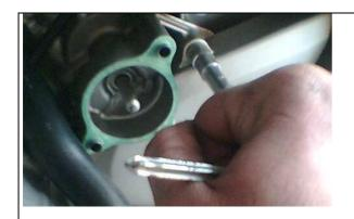
Pour revisser la visserie, à défaut de clé dynamométrique, visser simultanément les boulons jusqu'au contact des deux carter, puis procéder à ¼ de tour pour bloquer.
