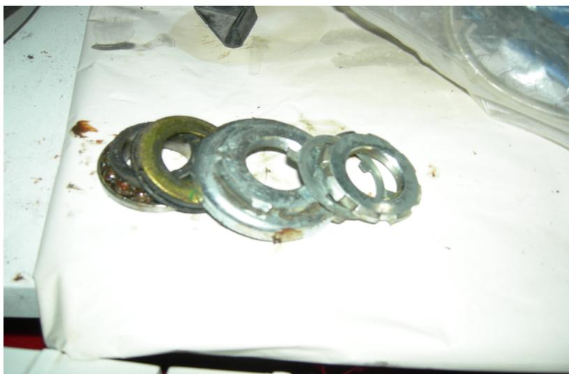
(Décomposition des éléments constituant le roulement supérieur)
