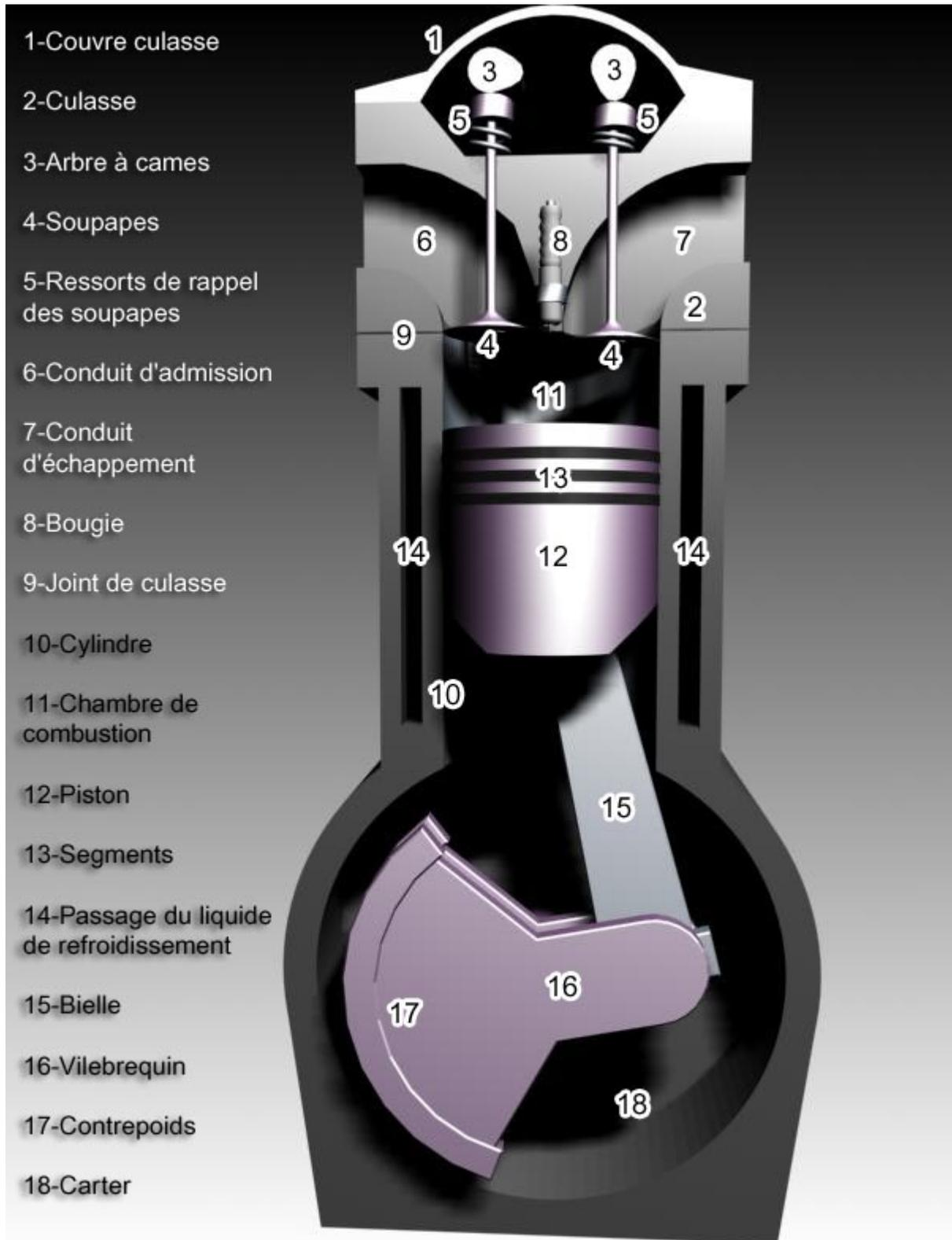
Le fonctionnement du moteur produit une chaleur intense, du fait des explosions comme tout simplement du fait du frottement des pièces entre elles. De ce fait, les limites physiques des matériaux sont rapidement dépassées d'où deux nécessités :
