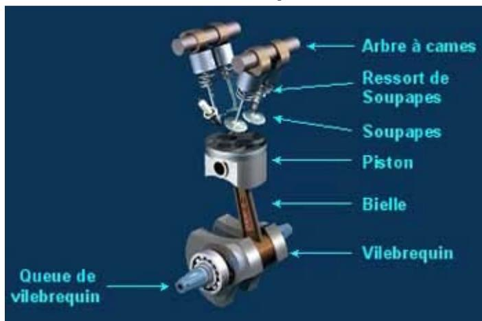
Le piston est animé d'un mouvement de va et vient au sein d'un cylindre (exactement comme le piston d'une seringue monte et descend dans la seringue selon qu'on le pousse ou le tire).
