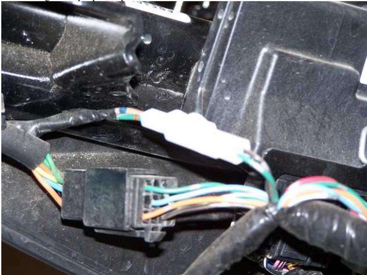
Fixation du fusible à l'aide de velcro (que j'avais) derrière le boîtier noir.
