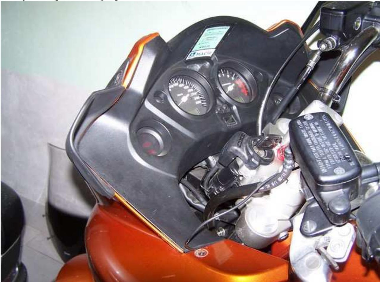
Faire une petite encoche inférieure au diamètre du flexible et le sortir en faisant des simulation avec le pare-brise (pour le camoufler au maximum).
