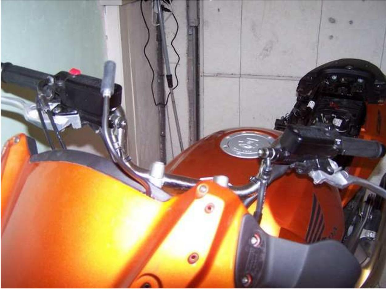
Voici le résultat avec mon pare-brise Ermax (la zone noire est plus haute que celle d'origine, ce qui me permet de le sortir d'avantage). L'encoche n'étant pas trop grande, le flexible est bien coincé et ne bouge plus.
