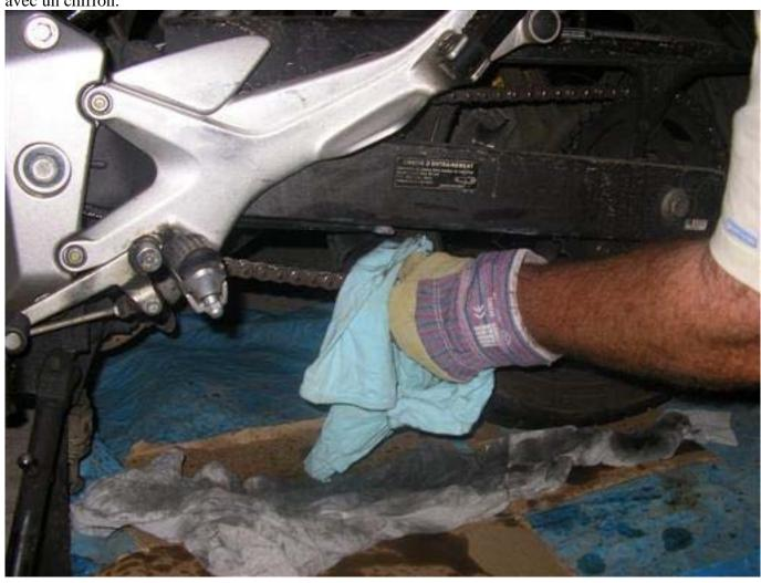
Après avoir secoué la bombe de graisse en aérosol, graisser la chaîne en tournant la roue et en veillant à ne pas en mettre sur le pneu....
