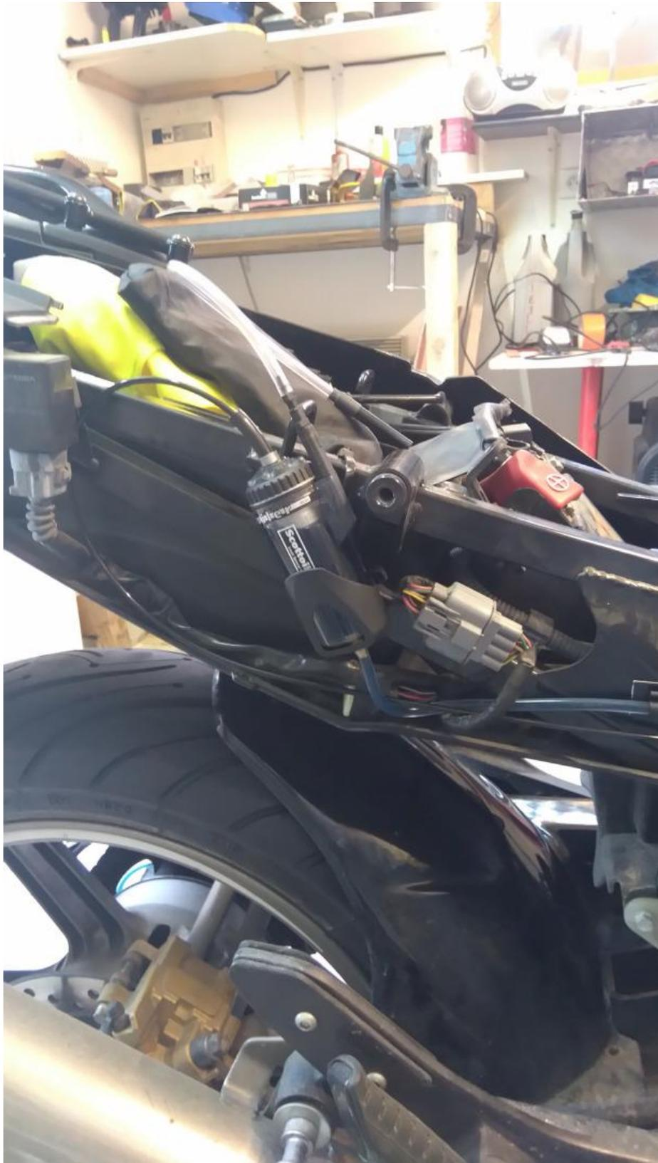
Déjà quelques kilomètres avec ce scottoiler. Je peaufine le réglage du débit, facile d'accès sous la selle, il suffit juste de contrôler que la chaîne soit toujours un peu humide.
