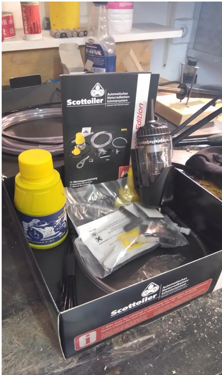
On reçoit dans le kit, 125 ml d'huile, le Scottoiler, les tuyaux pour la dépression et celui qui emmène l'huile à la chaîne. Des colliers Rilsan, 4 fixations à coller sur le châssis, un accessoire métallique qui va se passer sur l'axe de roue arrière et sur lequel on viendra ensuite y fixer le tuyau d'huile. Le té pour la dépression. Le petit bouquin qui explique comment procéder.
