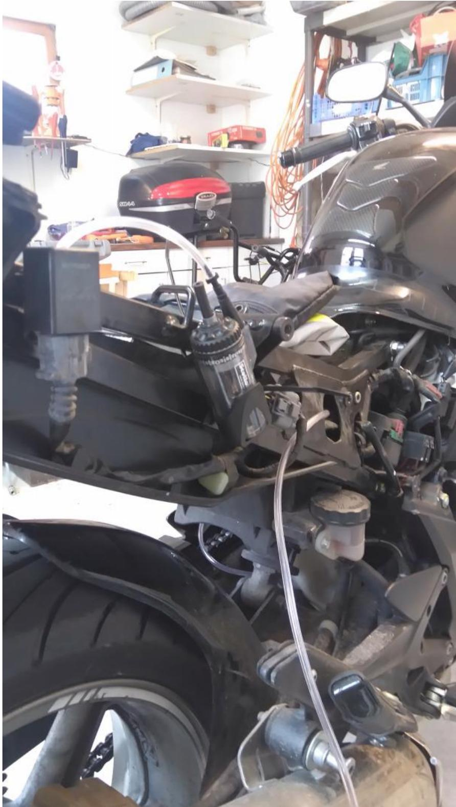
Je n'ai pas pu mettre la pièce sur l'axe de roue arrière car le bras est trop large, du coup je ne pouvais pas accéder à la chaîne. J'ai donc opté pour cette solution de fixer sur le filetage de la tension de chaîne.
