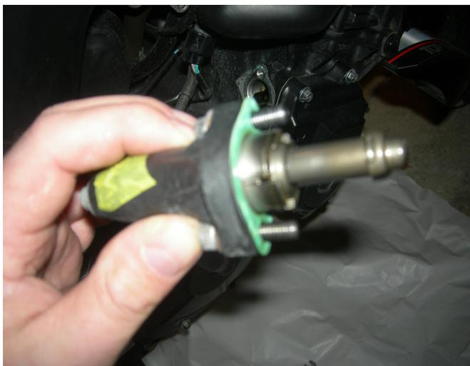
3. Vérifier l'état du tendeur et de la surface portante sur le moteur. Nettoyer avec un chiffon propre et non pelucheux. Veiller à ne rien faire tomber dans l'orifice.
