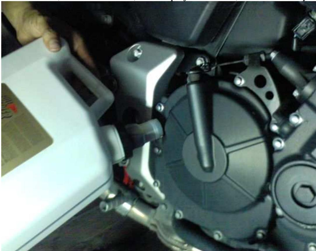
17- Après avoir refermé le bouchon, faire tourner le moteur un petit peu pour faire chauffer et relubrifier. Le voyant d'huile ne doit pas rester allumé. Il s'est allumé une fraction de seconde chez moi, le temps que l'huile reemplisse le circuit. Attendre 2 minutes que le niveau se stabilise, ouvrir le bouchon, essuyer la jauge avec un chiffon, retremper dedans sans visser, et contrôler le niveau. Au besoin, faire le complément.
