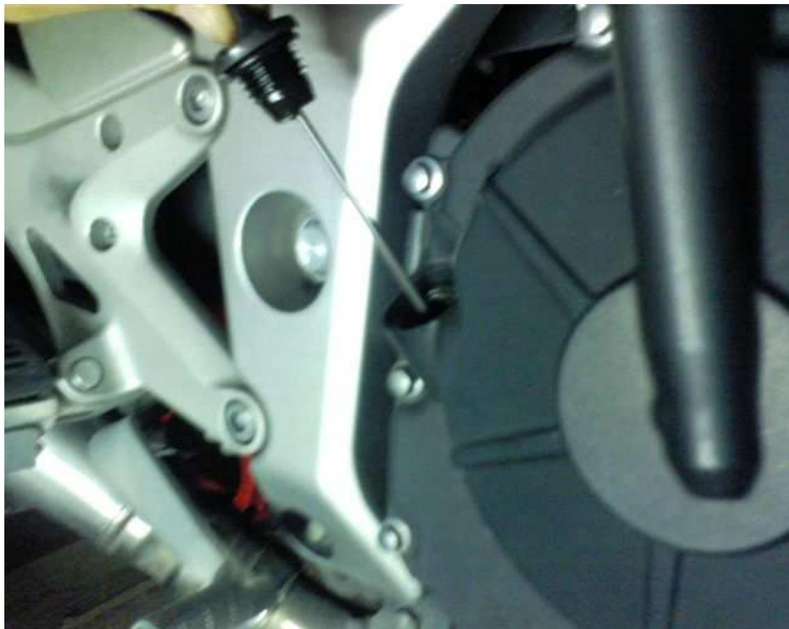
16- Remettre 3,8 litres d'huile. Bon, avec ce que j'ai mis à coté, la bouteille de 4 y est passée.
