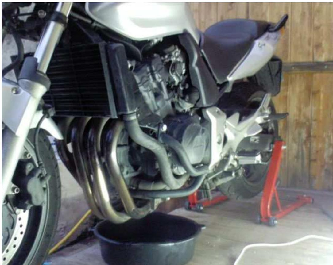
3- Dévisser la vis de purge à l'aide de la clef de 17. Si elle est bloquée, faire levier avec un tube. Ne pas forcer avec un outil mal adapté ou taper dessus au risque d'endommager la vis (l'arrondir) ou l'outil. La vis de purge est coté gauche, entre le sélecteur et le tuyau d'échappement, si la photo n'est pas explicite.
