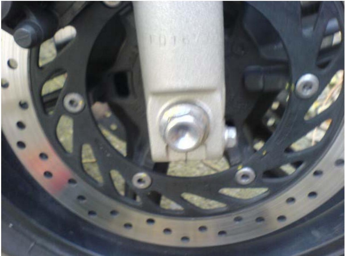
Même punition de l'autre côté; en principe, à l'endroit on est placée la vis, il y avait une fixation qui permettait de tenir la durite de freins qui a été remplacée par des durites aviation.
