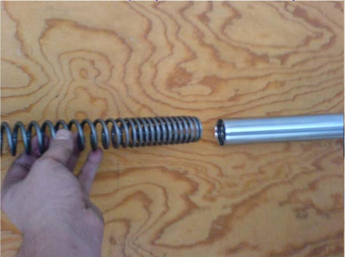
Après, on peut mettre la rondelle d'appui simple, puis l'entretoise longue, et, pour finir, la rondelle avec l'épaule vers le bas. On remet le bouchon A LA MAIN pour commencer, car le filetage est fragile. on le serre jusqu'à ce qu'il y ai contact. (attention, durant ces manipulations, il faut maintenir la fourche droite sinon elle se désamorçe).
