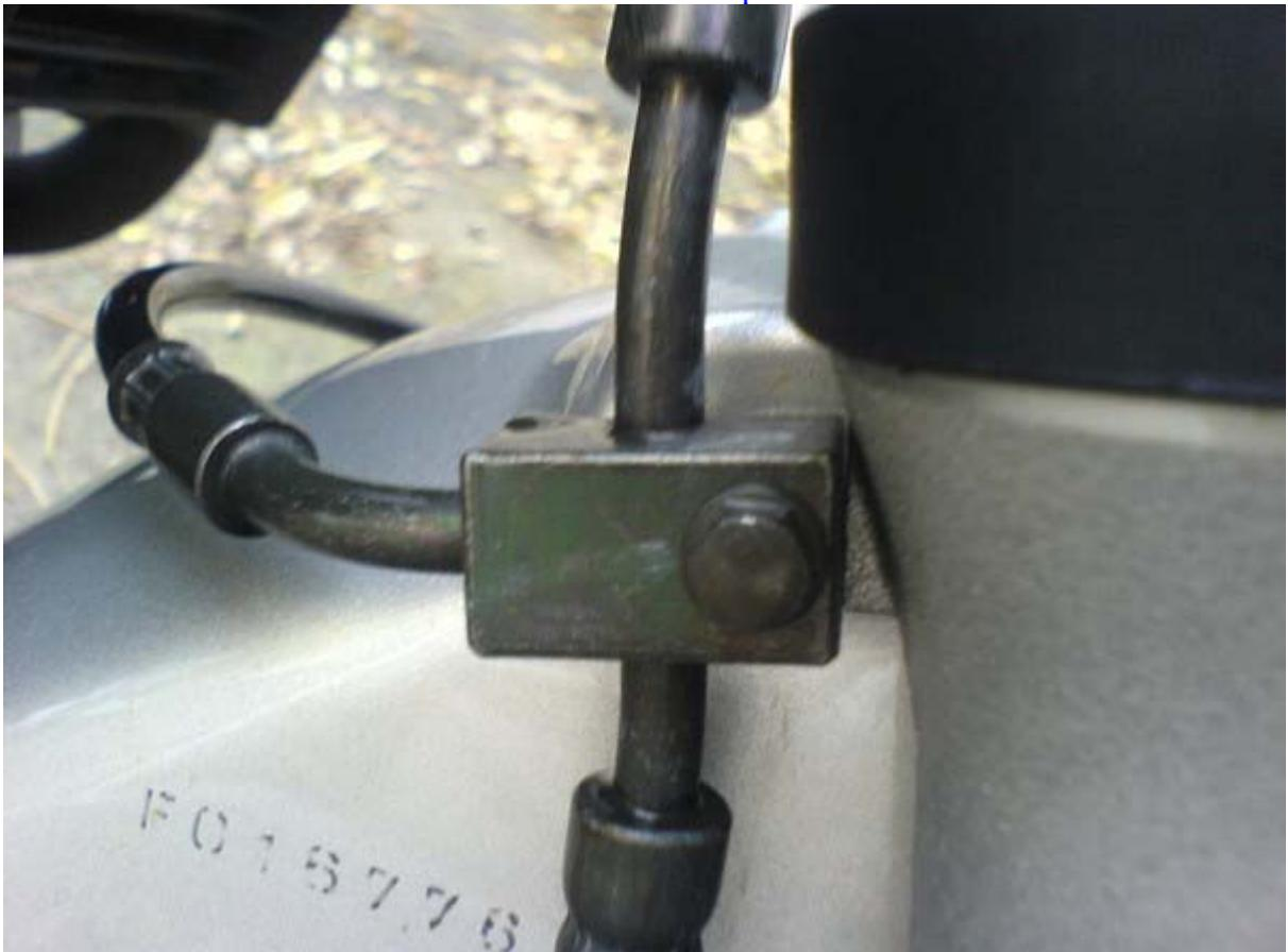
on dévisse les 2 fixations du garde boue (BTR 6) On les attache avec du fil de fer au cadre pour ne pas tirer sur les durits.
