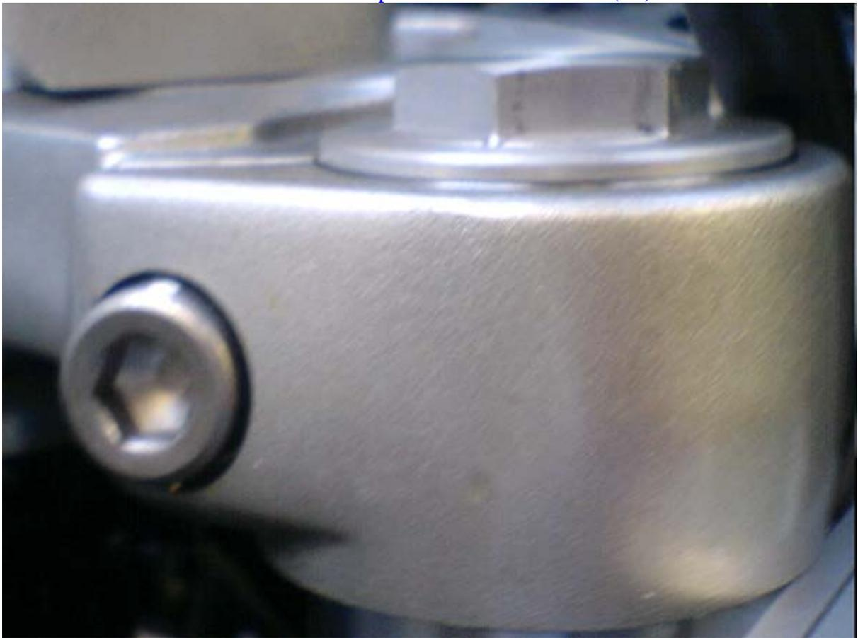
On débride le té inférieur en maintenant le tube, car il y a un risque qu'il glisse et tombe; mais il ne faut pas enlever le tube de fourche complètement, car on va se servir du té inférieur comme étau pour débloquer le bouchon de fourche.
